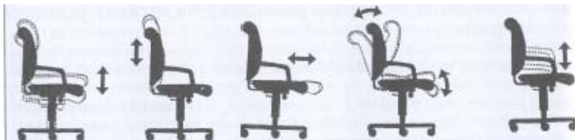
Obr. 3: Nastavitelné parametry sedadla (zdroj: 3, s. 130)
