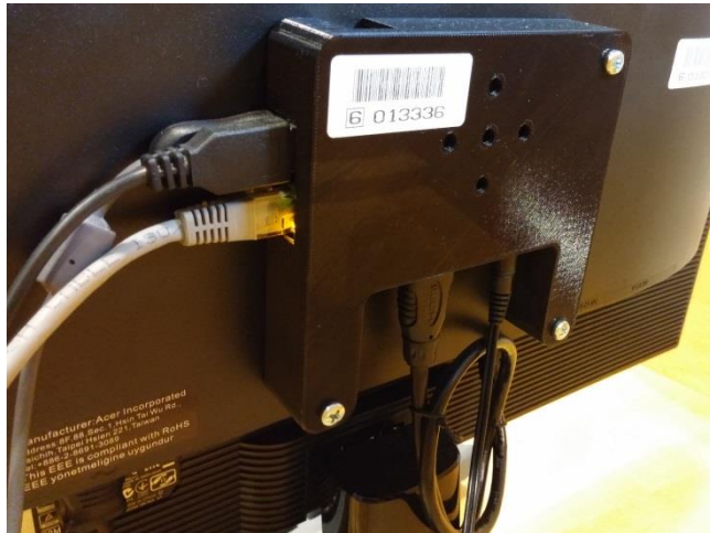
Obr. 2 Krabička s banánem uvnitř na zadní straně monitoru. Zdroj: autor příspěvku
