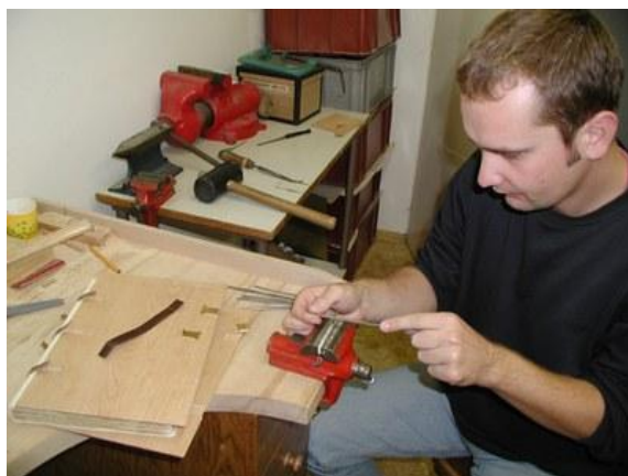
Zhotovení ochranných spon pro pevné sevření bloku
