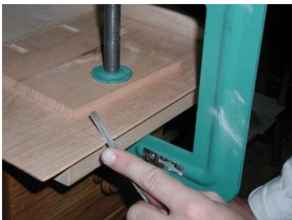
Profilace desky z bukového dřeva pro zapuštění vazů a kování
